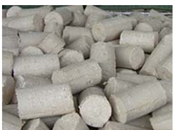
ピアノ製造工程から排出された木粉をペレット化してつくられた「木粉ブリケット」
