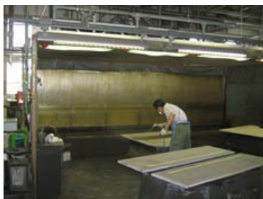
湿式塗装ブース（掛川工場）
