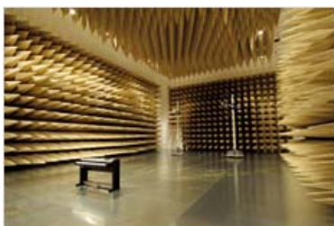
電磁波測定に使用する電波暗室
